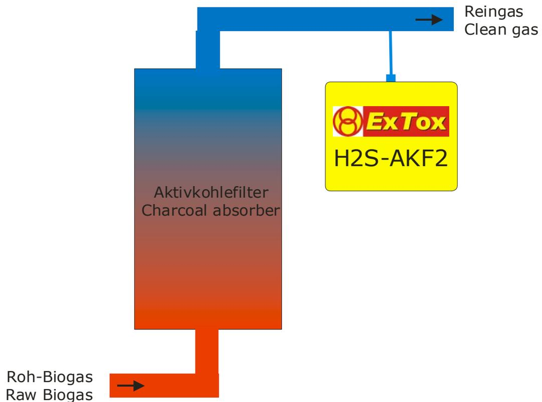
**Beschreibung:** Durchbruchüberwachung von Aktivkohlefiltern für Biogasanlagen mittels H<sub>2</sub>S-Messung.
