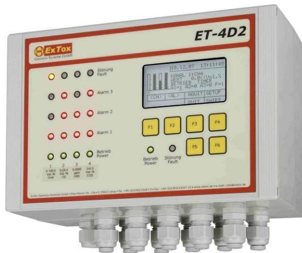
**Beschreibung:** Gaswarnzentrale zur Messung brennbarer und/oder toxischer Gase sowie Sauerstoff. Rauchmelder-Option. Grafikdisplay. Menügeführte Konfiguration. 3 Alarmschwellen pro Kanal. 12 frei konfigurierbare Relais-Schaltausgänge. Analogausgänge 4...20 mA (nur ET-4DA2).
